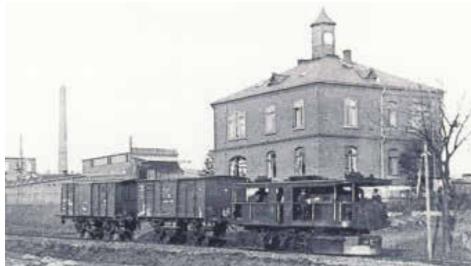
Der Zug der Rollbockbahn beim Bedienen des Anschlussgleises Deutsche Wollentfettung in Oberheinsdorf vor 1930. (Foto: Sammlung Werner Nitzschke)
